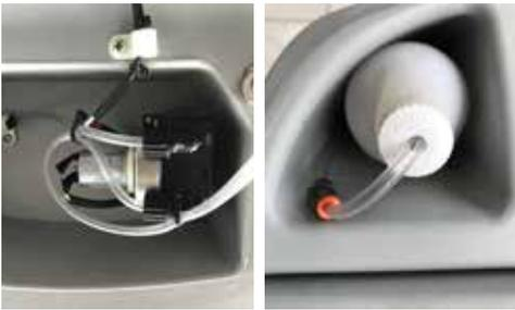
Trion 5070 può essere dotata di serie del sistema di regolazione del detergente la cui percentuale (fissa con 4 valori: 0,2%-0,5%-1%-1,5%) è impostata dal display con una semplice operazione. Cio' consente una precisa calibrazione della quantità di prodotto chimico in funzione dell'applicazione. Si evitano quindi sia sprechi di detergente rispetto alla dosatura manuale nel serbatoio dell'acqua che ristagni di prodotto nel serbatoio.
